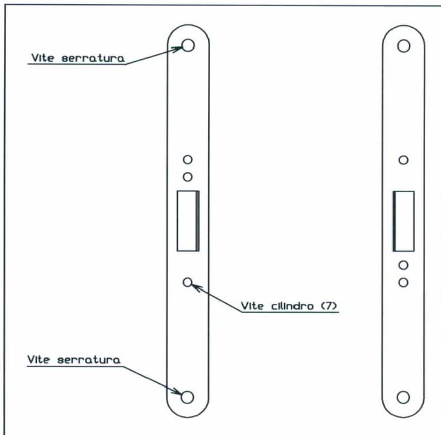
**N.B.:** L'operazione va eseguita prima di montare il sacchetto accessori (maniglia, cilindro, ecc.)
