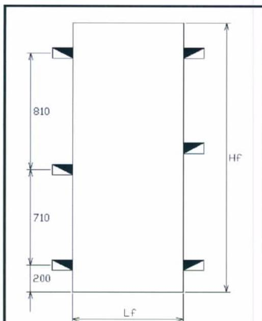
Lf x Hf = Dimensioni foro muratura per porte con telaio a "Z"
